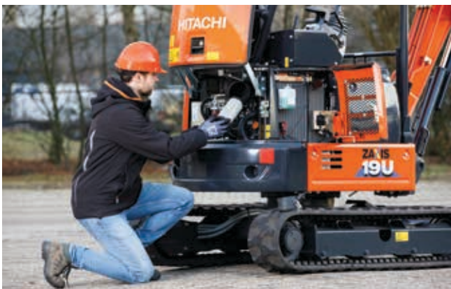
De eenvoudig te openen kappen bieden snelle toegang.
