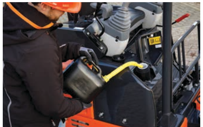
Er is voldoende ruimte rond de opening van de brandstoftank, voor eenvoudig tanken.
